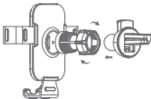
2. Une fois le support du téléphone installé dans la bouche d'aération ou sur le tableau de bord, placez le téléphone dans les bras de serrage du support et laissez le poids du téléphone actionner le système de serrage.
